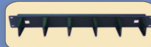
14.6832 PANEL 1U ΓΙΑ ΟΡΓΑΝΩΤΗ ΚΑΛΩΔΙΩΝ Περιλαμβάνει τις βίδες για τη στήριξη του στο Rack (σετ 4 τεμάχια). Χρώμα RAL 9005
